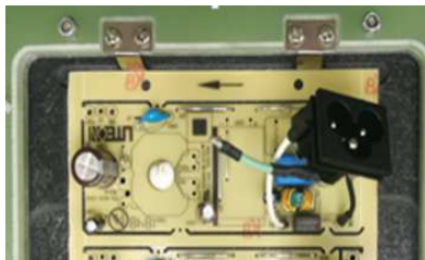
圖1. T050與PCB之間須點散熱固定RTV膠，勿過量超出PCB限制區
